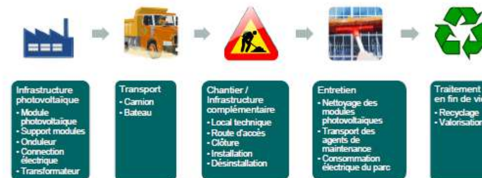
Figure 1: Périmètre du système photovoltaïque analysé
