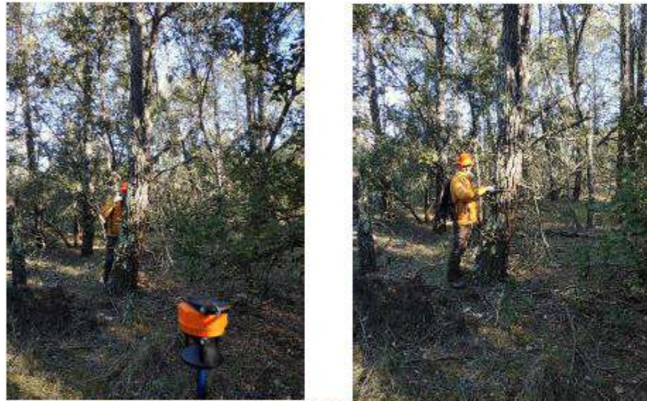
Figure 2 : Mesure d'un arbre sur une placette PCQM : Distance au centre et diamètre de la tige
